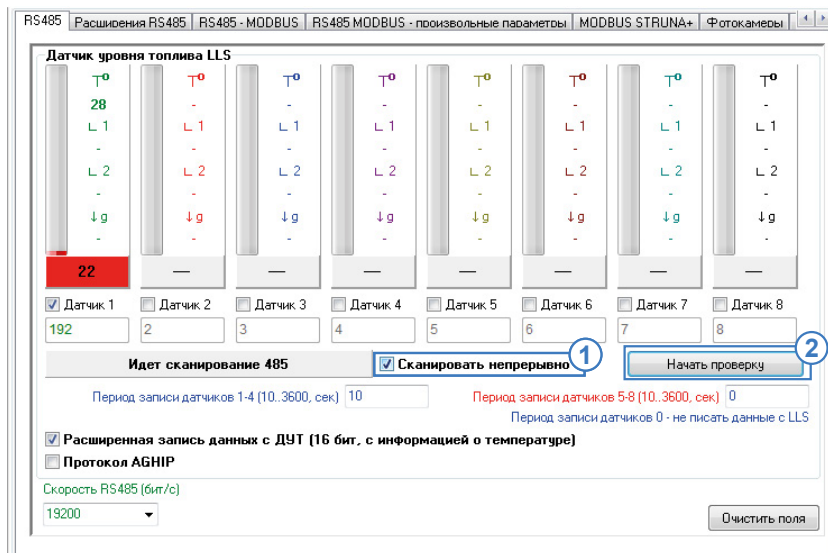
Рис.36. Проверка работы контроллера «АвтоГРАФ» с датчиками «ТКАМ» по протоколу LLS.
